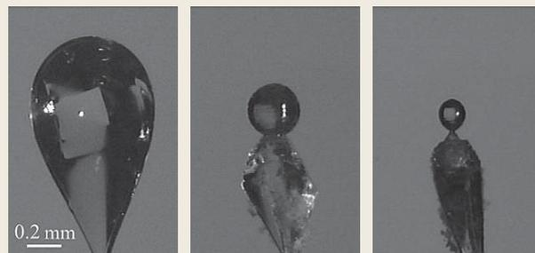
料に大きな温度上昇を生じるため、熱変性を回避しなければならないタンパク質結晶の加工においては不適である。これに対して、深紫外光は、赤外光や可視光に比べて光子エネルギーが高く、パルスレーザー光を用いることで、発熱による悪影響が少ない高精度で平滑な加工が達成できるため、生体系材料の加工において都合が良いと考えられる。また、レーザーアブレーションの特性は、ターゲットの吸光度に依存する。タンパク質は波長300 nm以下の紫外光を吸収し、特に、波長200 nm以下の深紫外領域では非常に高い吸収係数を持つ。したがって、動作波長190 nm~200 nm程度の短パルス深紫外レーザーが、タンパク質結晶の加工に特に適した光源と判断することができ、本研究で開発した動作波長193 nmの深紫外固体レーザーによるタン
